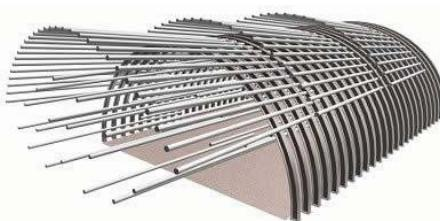
図-1 長尺鏡ボルト工
