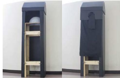
図4 外部の光を遮断した試験環境
